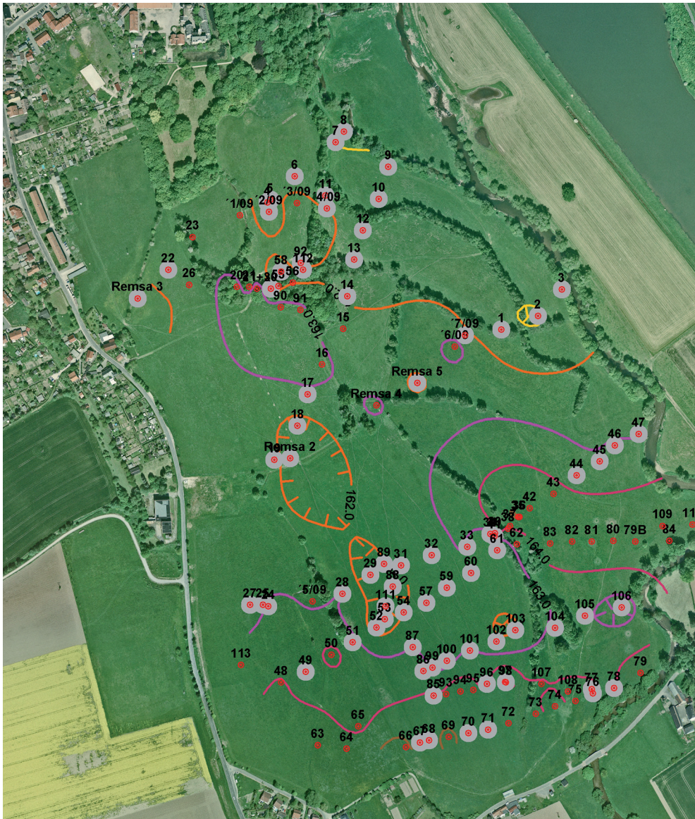
Abb. 8: Verbreitung der grauen Schluffmudde (grau umrandete Bohrpunkte) im Untersuchungsgebiet in Bezug auf die Oberkante der Kiese und Sande (Isolinien-Darstellung, Angaben in m NHN).
