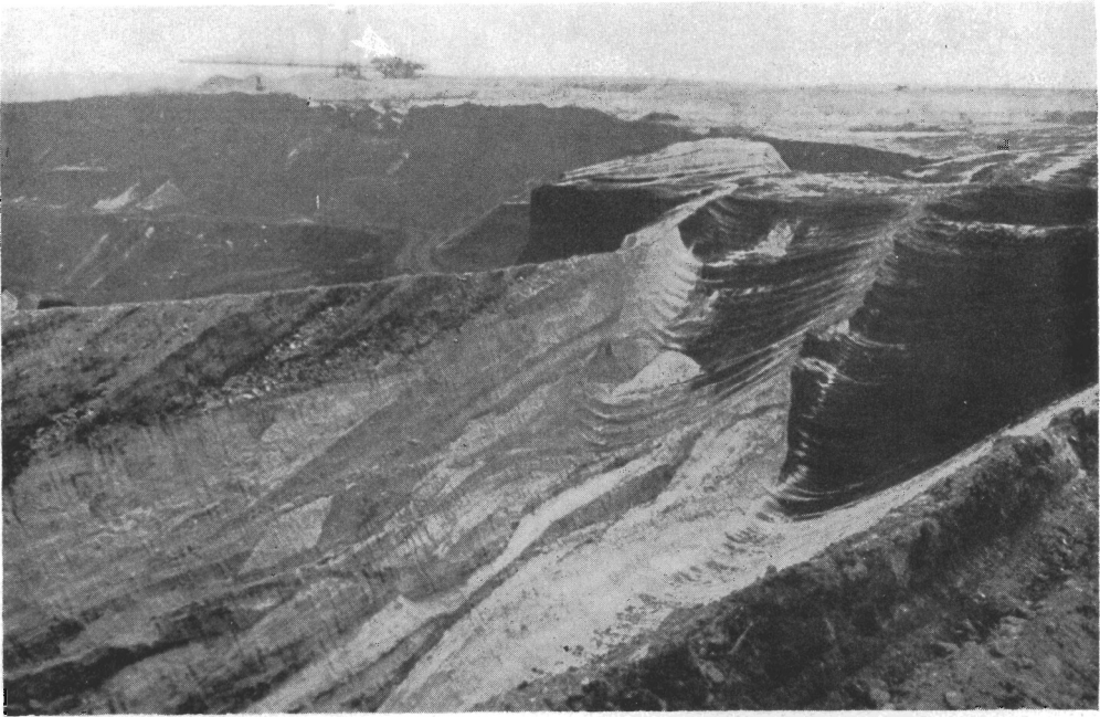
Abb. 3. Tagebau Mücheln-Süd, Ostrand einer Kiesrinne, unten Schmelzwassersande, oben Muschelkalkschotter der Körbisdorfer Terasse
