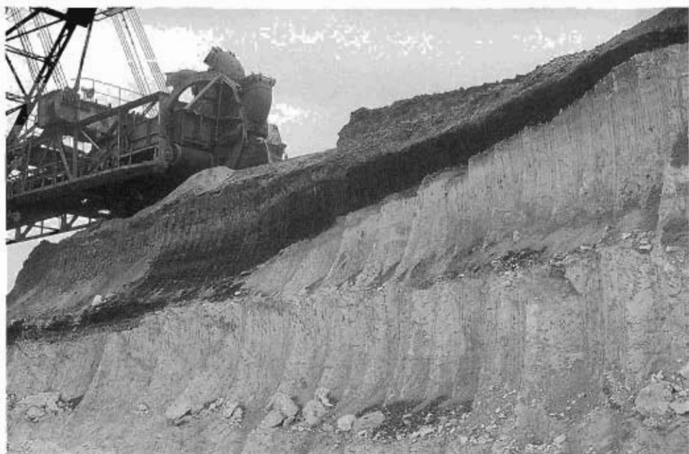
Bild 20. Nördlicher Hang eines aus tiefgründig kaolinisierter präkambrischer Leipziger Grauwacke (Wechsellagerung von Grauwacke und Schiefer) bestehenden Rückens, eines „Kaolinberges“ der Bergleute, an dem das in der Umgebung rund 8 m mächtige obereozäne Bornaer Hauptflöz allmählich auskeilt. So hat man sich den Fuß der in braunkohlenzeitlichen Schichten des Tief- und Hügellandes ertrunkenen „Inselberge“ vorzustellen.
